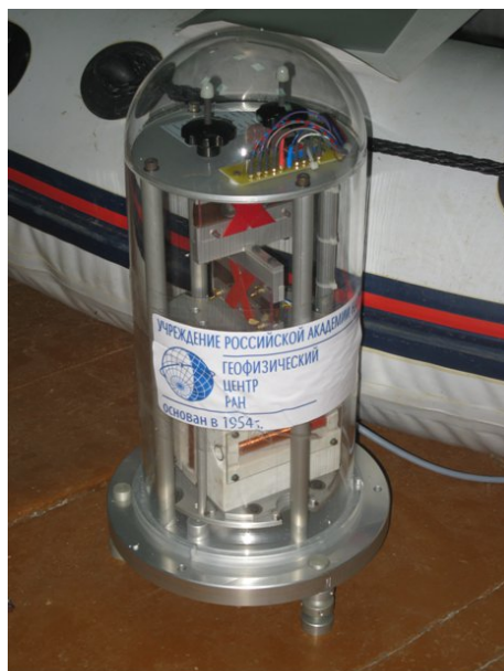
Рисунок 6.14. Вариометр ГЦ РАН в главном здании геобиостационара «Ротковец».
