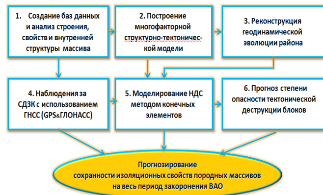
Рис. 3. Этапы технологии прогноза стабильности геологической среды при выборе СТБ для подземной изоляции ВАО
