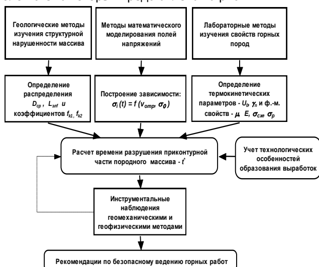
Рис. 44. Блок-схема метода прогнозирования времени разрушения приконтурной части породного массива на удароопасных месторождениях.
