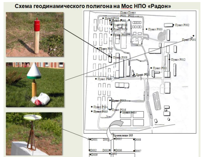
Рис. 16. Схема геодинамического полигона на площадке Мос НПО «Радон»
